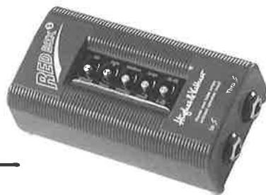
Hughes & KettnerのRED BOX 5は、ギター・アンプのラインおよびスピーカー出力の信号を、周波数補正によって12インチ・スピーカー4本入りキャビネットの特性を再現した、マイクロフォン・レベルのバランス・シグナルに変換します。これを使えば、ギター・アンプのスピーカー出力やライン出力、あるいはエフェクト・センド端子の出力信号を、ミキサー卓のマイク入力に直接送ることができます。
