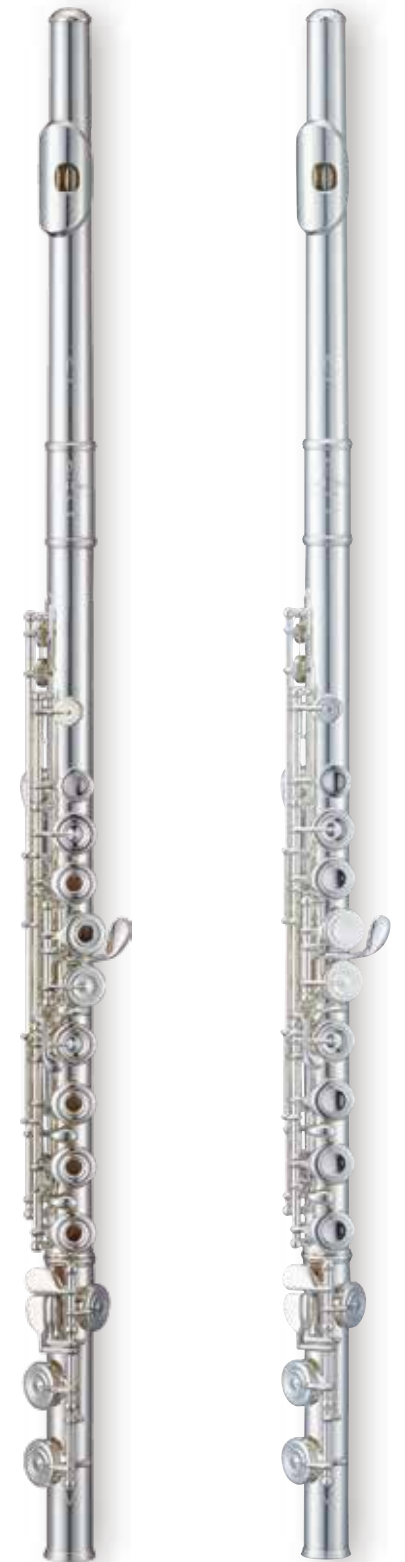
Photo: Elegante Primo / Dolce Primo (左) F-EP925/RE 管体銀製(Ag925)、座金/ポスト/リング洋銀製、ドローン(引き上げ)トーンホール、リングキ(オフセット)、キメカニズム洋銀製、C足部管、Eメカニズム (右) F-DP/E 頭部管銀製(Ag925)、管体/座金/ポスト/リング洋銀製(銀メッキ仕上げ)、ドローン(引き上げ)トーンホール、カバードキ(オフセット)、キメカニズム洋銀製、C足部管、Eメカニズム
