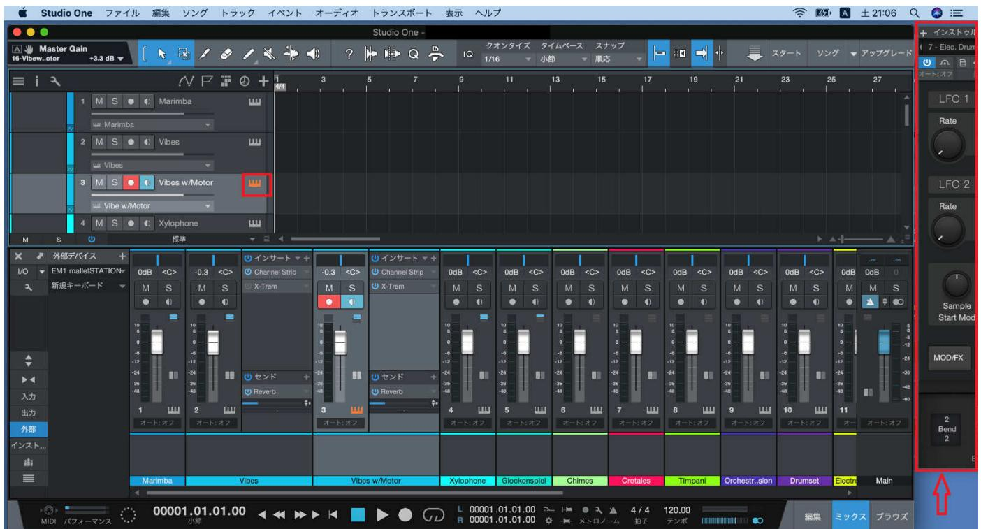
この時、音源のウインドウ(タイトルが「+インストゥルメント」で鍵盤が下にレイアウトされている大きめのウインドウ)が開きますが、その開いた場所が右の画面の端のギリギリの辺りに見えることがあるので、(上図の赤矢印部分)操作しやすいように中央の方へ移動させておきます。
