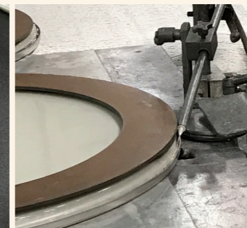
ポリウレタン充填(フィルムを固定)
