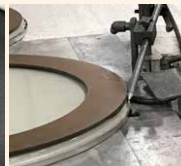
ポリウレタン充填 (フィルムを固定)
