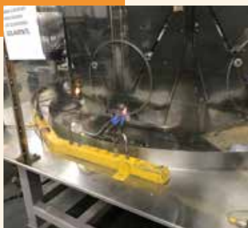
アルミチャンネルの溶接
