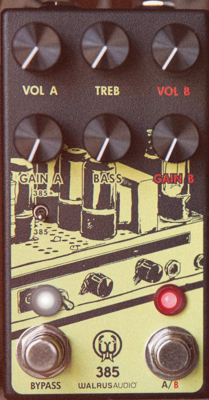
**Volume B** : 設定Bの全体の音量をコントロールします。
