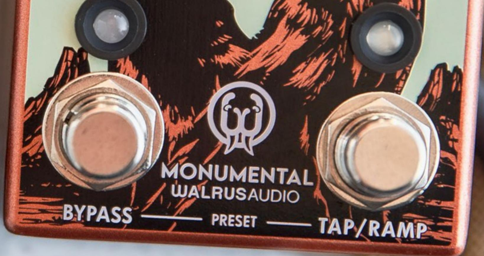
**PRESETS:** 本機には、3つのオンボードプリセットと、追加のライブ・モードが実装されています。各プリセットは、ペダルで使用可能なすべてのパラメータを保存し、呼び出すことができます。バイパス・スイッチとタップ・テンポ・スイッチの両方を同時に押すと、利用可能なプリセットが切り替わります。
