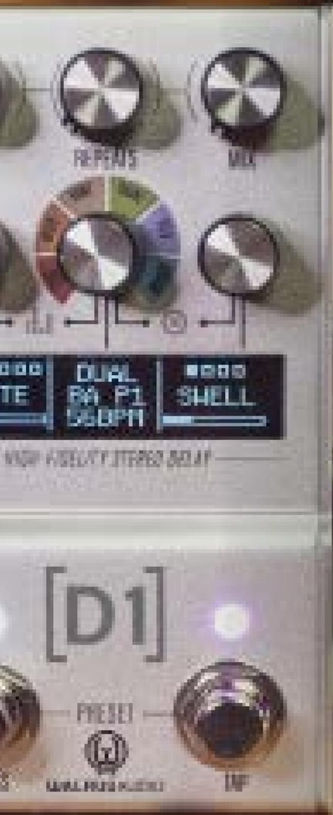
**RIGHT ENCODER** - 右エンコーダーを使用して、BPM、ダッキングなどのディレイ機能を微調整します。エンコーダーを押し下げて各オプションを循環させ、目的のコントロールに到達するまでエンコーダーノブを回して調整します。あるいは、エンコーダーを押し下げて回し、オプションをスクロール、放すことで選択できます。下記に記されているすべてのオプションがすべてのプログラムに適用されるわけではありませんので、ご注意ください。
